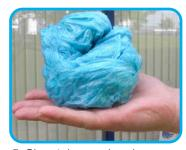
7. Glass Advanced se despega a mano. No retire el producto en condiciones de frío extremo, ya que tendrá una estructura frágil y no se despegará correctamente. Si hay áreas con capas delgadas o exceso de rociado, salpique alcohol isopropílico en la superficie para ayudar con la remoción. El recubrimiento despegado se puede compactar en una bola pequeña y desecharse.
