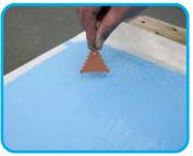
3. Utilice un medidor de película húmeda para comprobar que el espesor de película húmeda (WFT) del revestimiento sea de 10 mils como mínimo.
